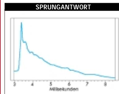
Der Frequenzgang der Pearl ist fast perfekt gerade, sogar der berühmte Anstieg der Focal Hochtöner bei hohen Frequenzen ist nur noch zu erahnen. Die Box ist mit im Mittel sechs Ohm völlig impedanzunkritisch. Der Wirkungsgrad liegt mit rund 84 Dezibel bei 2,83 Volt nicht extrem hoch, aber im „ungefährlichen“ Bereich. Sprungantwort? Wie bereits erwähnt praktisch perfekt. Ein Zeitversatz zwischen den drei Treibern ist faktisch nicht zu erkennen. Erstklassiges Handwerk!
